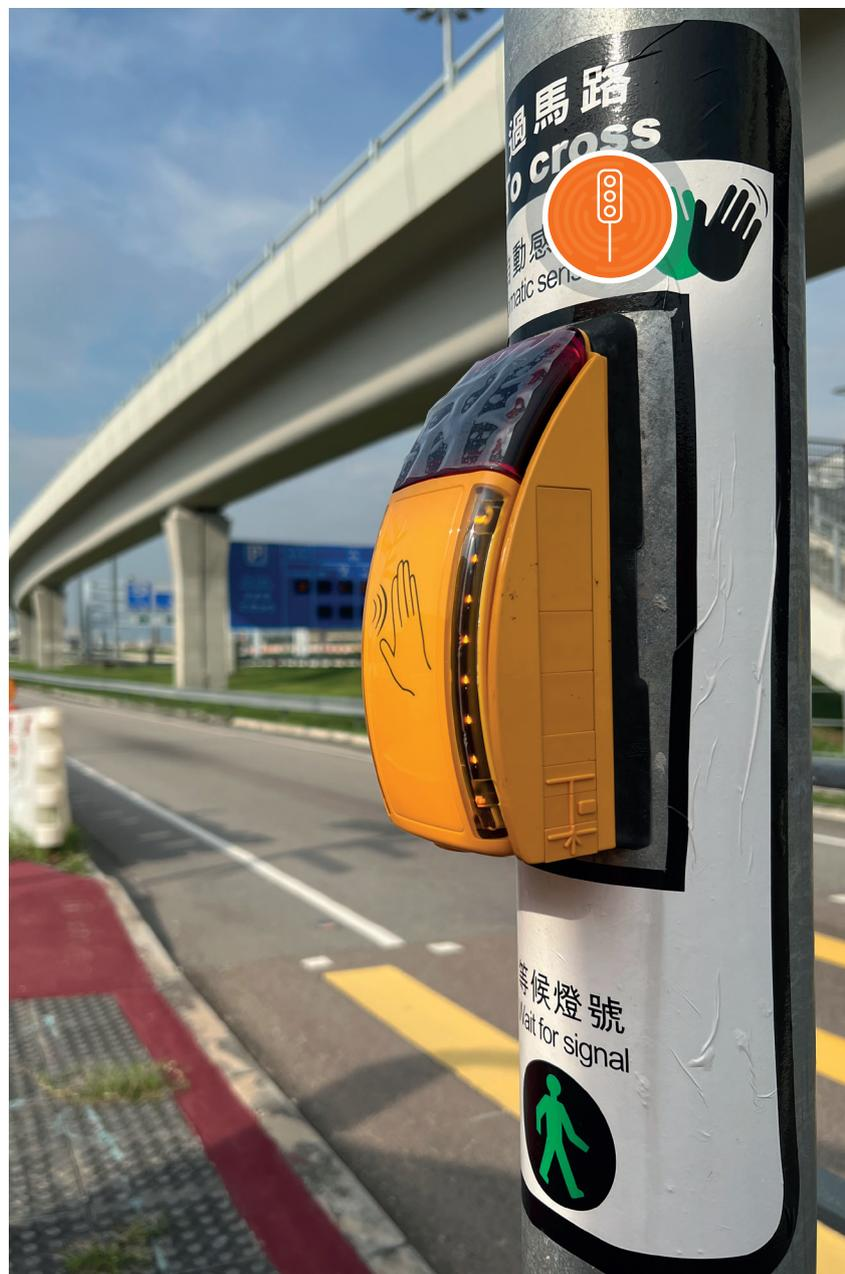
Die berührungslosen Radartaster sind ebenfalls im net.2-Netzwerk eingebunden, so dass die einzelnen Tasterfunktionen über das Netzwerk kontrollierbar sind, während nur zwei Adern zur Energieversorgung benötigt werden. Die beiden LED-Leuchtmodule sind dimmbar und können bei Dunkelheit mit reduzierten Leuchtstärken betrieben werden.
